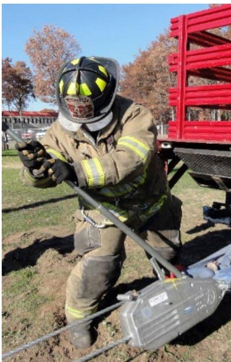
Le treuil à câble passant Tirfor est un appareil de grande polyvalence. Son ergonomie et sa légèreté facilitent son transport, son installation et sa manipulation. Il peut être utilisé dans de multiples configurations et situations, en travaillant avec de grande longueur de câble. Il peut tirer, lever et positionner des charges au millimètre. Sa capacité peut multiplier à l'aide de poulie de mouflage (\*).
